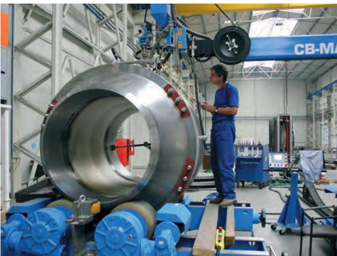
Automatyczne spawanie kurek kulowy DN 1400 AG
