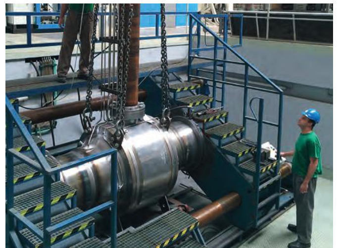
Test ciśnieniowy kurek kulowy na terenie ARMATURY Group
